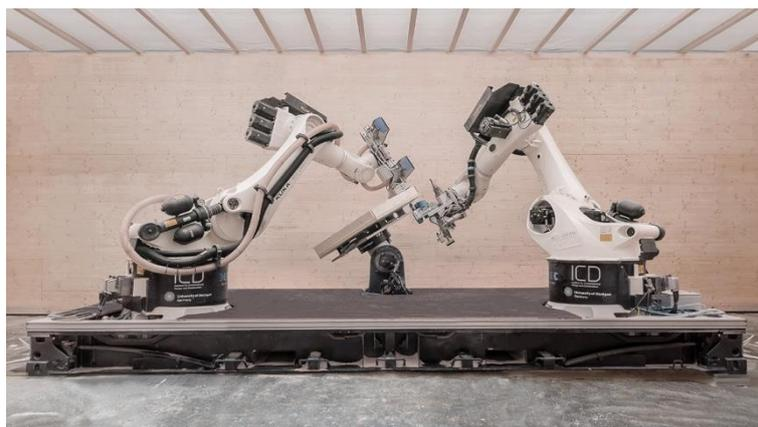
**Abb. 3. Roboter-Holzfertigungsplattform, ICD/ITKE Universität Stuttgart**
